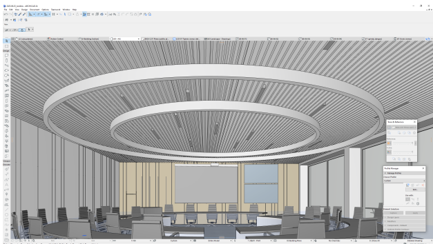
3d vaizdas (Didžioji posėdžių salė). Lamelių ir linijinių šviestuvų bei individualių pakabinamų šviestuvų įrengimo pavyzdys
